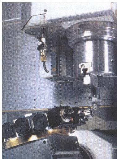
Obr.1.14 Pětiosé provedení s NC osami X, Y, Z, B a C
