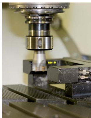
Obr. 5.3 Kontrola jednotlivých břitů a tvaru břitů laserovou sondou [ 15 ]
