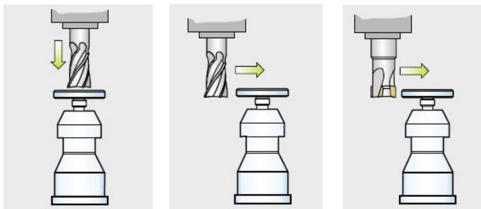
Obr. 5.1 Měření délky, poloměru a opotřebení nástroje pomocí nástrojové sondy [ 15 ]
