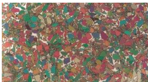
Obr. 2.17 Mikroštruktúra neoxidickej keramiky \text{Si}_3\text{N}_4 , zv. 200x, leptané na farebnú mikroskopiu.
