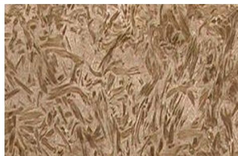
Obr. 2.14 Mikroštruktúra zmesnej keramiky, zv. 200x, leptané na farebnú mikroskopiu.
