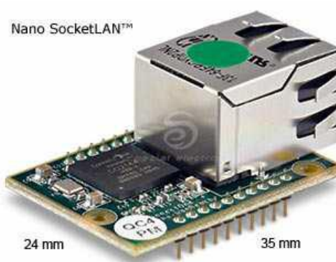
Obr. 24 Miniaturní modul Nano SocketLAN
