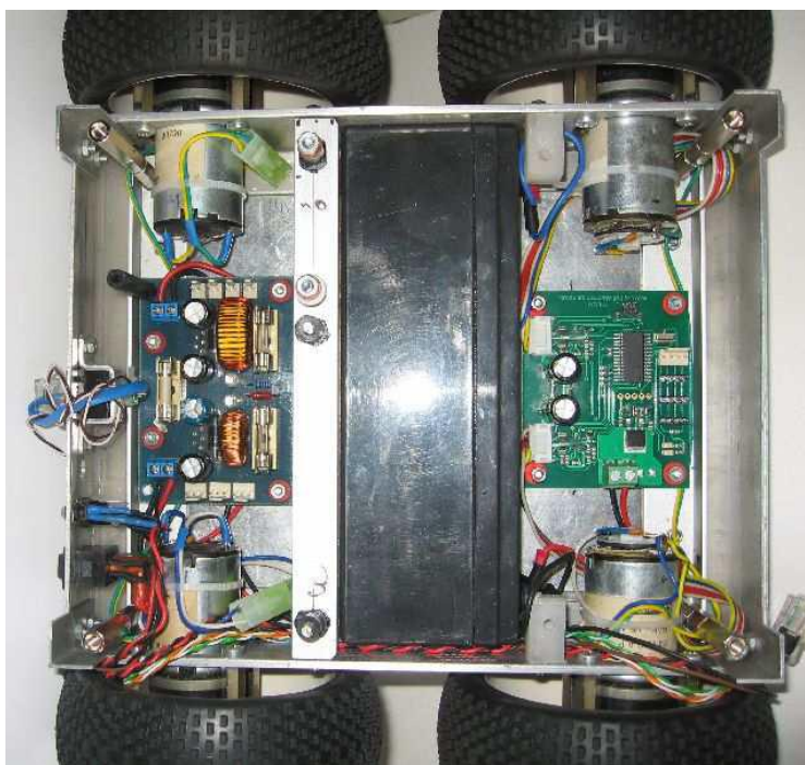
Obr. 30 Pohled na model se zdrojem a výkonovým stupněm pohonů
