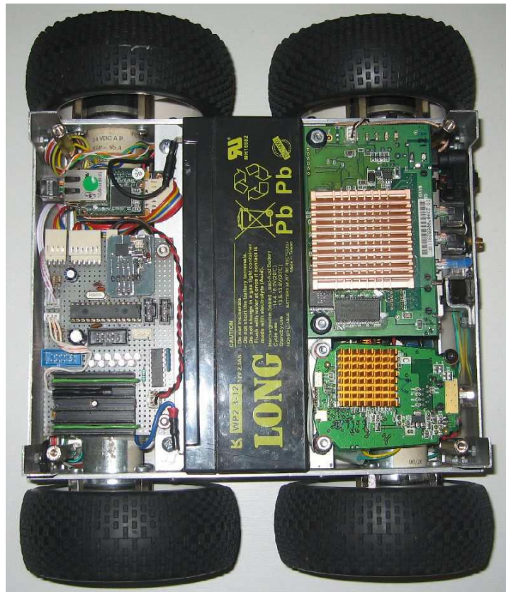
Obr. 31 Osazení modelu řídicí jednotkou a moduly v horní části modelu
