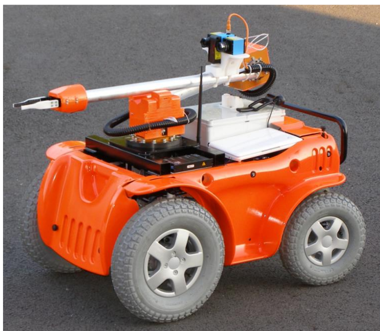
Obrázek 2.2 - Mobilní servisní robot HERCULES [2.1] osazený manipulační nástavbou se třemi stupni volnosti, dvoučelistovým efektořem a stereovizní kamerovou jednotkou
