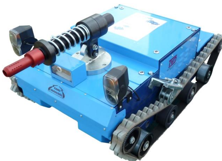
Obrázek 2.1 - Mobilní servisní robot ARES, osazený vodním rozstřelovačem, určeným pro destrukci nástražných výbušných systémů
