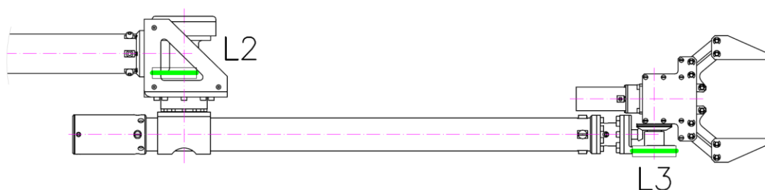
Obrázek 4.4 - Umístění laserové diody L2 a L3
