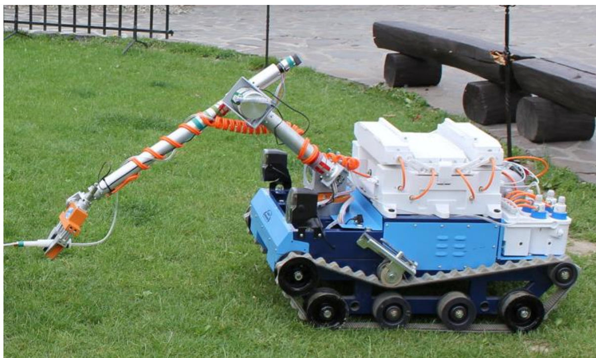
Obrázek 6.1 – Mobilní robot ARES osazený manipulační nástavbou a subsystémem pro odběr kapalných a plyných vzorků
