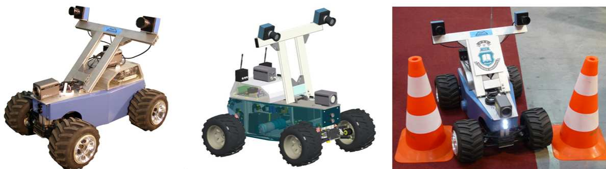
Obrázek 3.21 – Příklad čtyřkolového robotu pro pořizování 3D metrických dat
