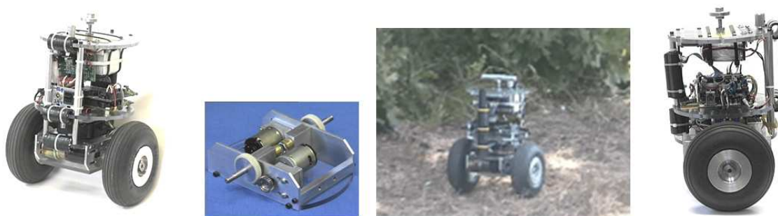
Obrázek 3.15 – Příklad konstrukce dvojkolového robotu
