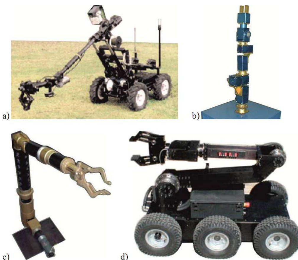
Obrázek 2.10 – Příklady řešení subsystému akční nástavby
