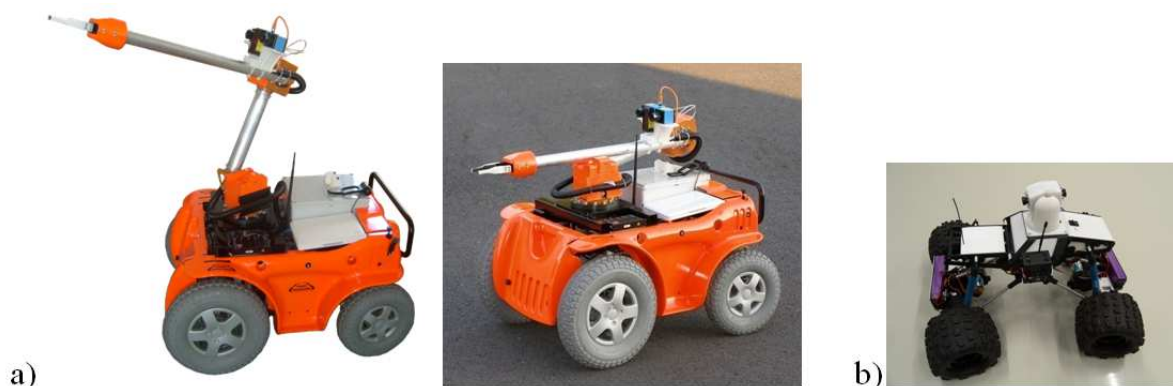
Obrázek 3.20 – Příklad čtyřkolového robotu pro manipulační úlohy a monitoring
