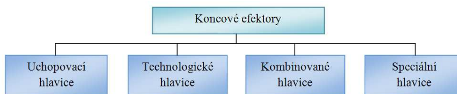
Obrázek 2.12 – Klasifikace koncových efektorů
