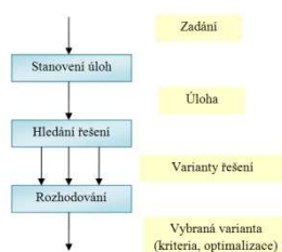
Obrázek 2.26 – Algoritmus základních kroků metodiky konstruování
