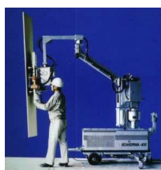
Obrázek 4.1 – Robot pro manipulaci s tabulemi skla a) a manipulátor pro osazování dveří b)
