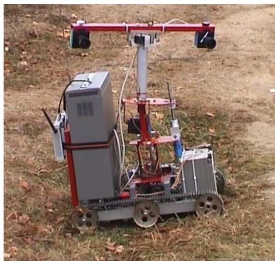
Obrázek 5.14 – Prototyp pásového robotu pro pořizování 3D metrických dat
