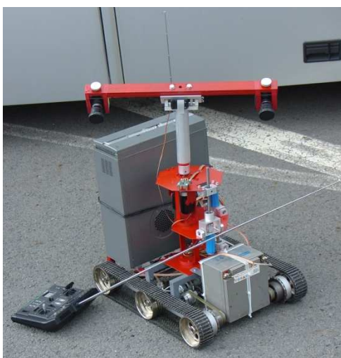
Obrázek 5.14 – Prototyp pásového robotu pro pořizování 3D metrických dat
