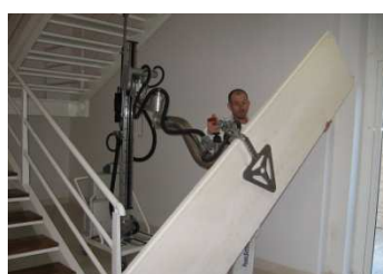
Obrázek 4.1 – Robot pro manipulaci s tabulemi skla a) a manipulátor pro osazování dveří b)
