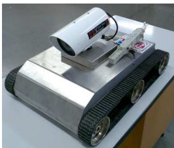
Obrázek 5.15 – Prototyp pásového robotu a 3D model v současném provedení
