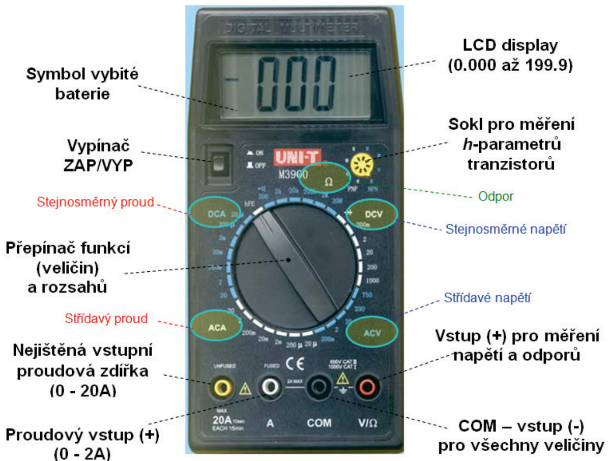
Obr. 3.1 Digitální multimetr M3900.
