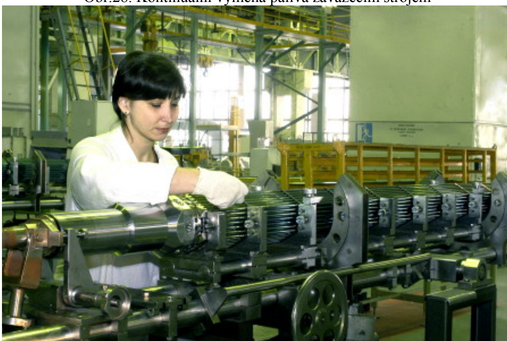
Obr.29. Montáž palivových elementů do palivového článku typu VVER
