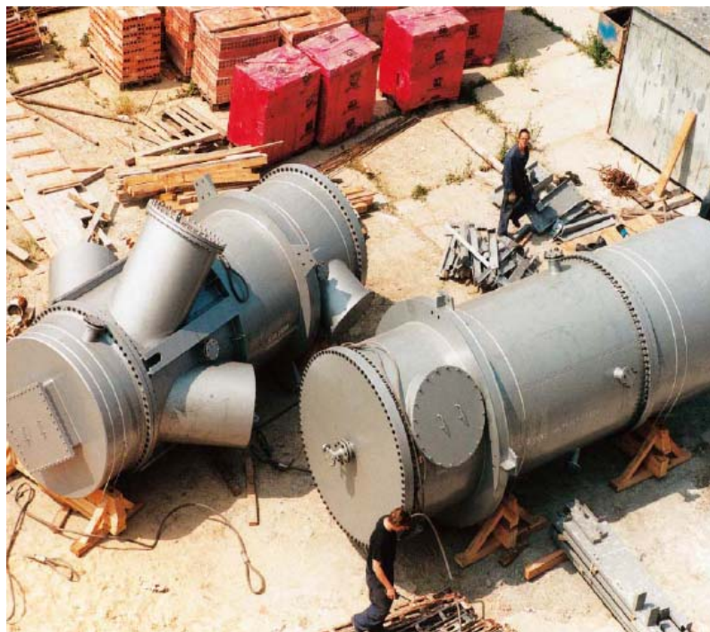
Obr. 76. Spalovací pec s dohořivací komorou NUKEM
