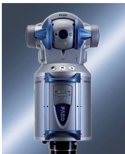
Obr. 52 Laser tracker a jeho schéma určení pozice reflektoru
