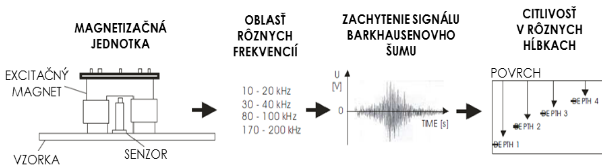
Obr. 7 Schéma merania zvyškových napätí s využitím Barkhausenovho javu [21]
