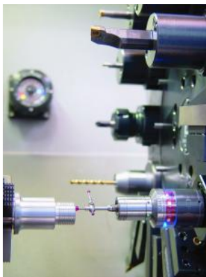
Obr. 79 Kontaktná obrobková sonda TC53-10 [38]
