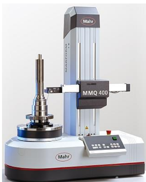
Obr.28 Kruhovitosť meraná na kruhomeri s rotačným stolom [18]
