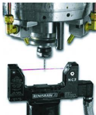
Obr. 77 Kontaktná nástrojová sonda TC76 [9] Obr.78 Bezkontaktná nástrojová sonda [44]
