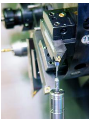
Obr. 77 Kontaktná nástrojová sonda TC76 [9] Obr.78 Bezkontaktná nástrojová sonda [44]
