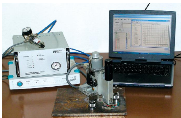
Obr. 5 Příklad odvrtavacej súpravy SINT-MTS 3000 s vyhodnocovacím softvérom
