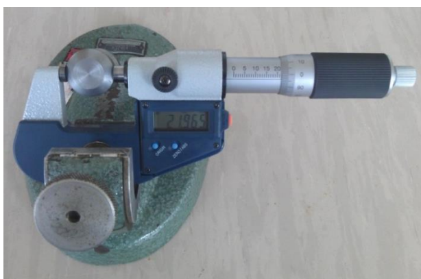
Obr.24. Dvojbodová metóda merania odchýlky kruhovitosti
