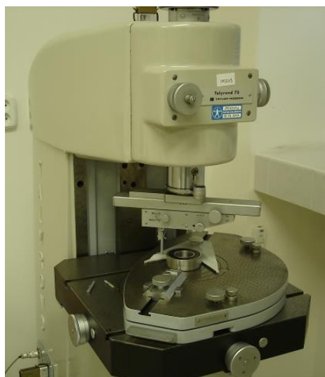
Obr.27 Kruhovitosť meraná na kruhomeri s pevným stolom
