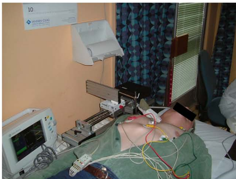
Obrázek 1 – Vytvořené zařízení na 3D ultrazvukové zobrazení a měření aterosklerotického plátu
