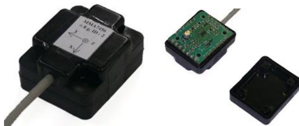
Obr. 46 Sensor s jednočipovým mikroprocesorem, krabičkou a vývodem CAN sběrnice
