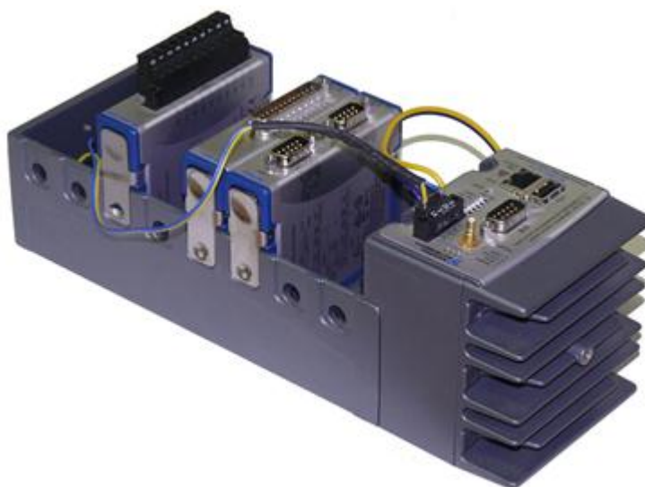
Obr. 37 Měřicí ústředna cRIO se zásuvnými kartami
