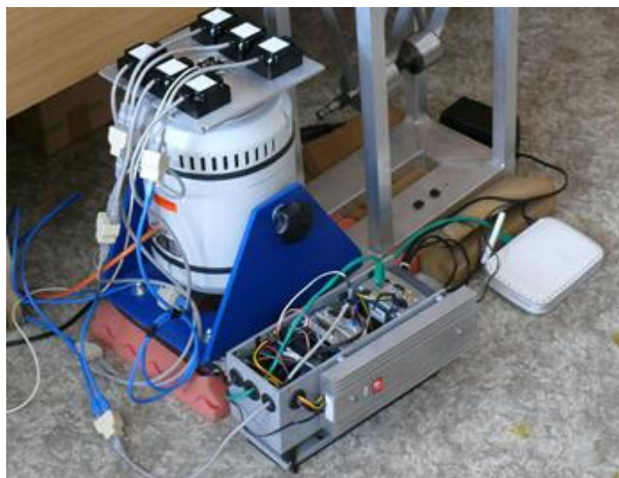
Obr. 41 Umístění snímačů na společné desce na vibrátoru
