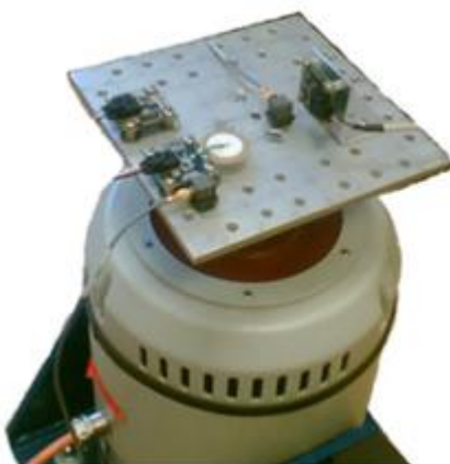
Obr. 36 Vibrátor Tira s připevněnými snímači
