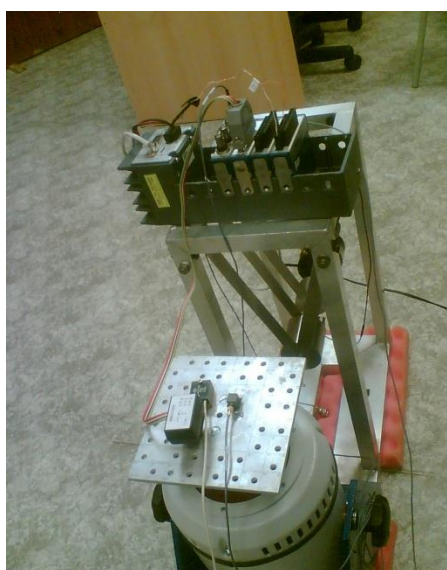
Obr. 30 Měřicí sestava s cRIO, hliníkovou deskou se senzory a vibrátorem Tira
