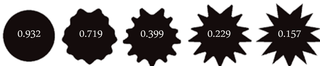
Obr. 14.6 – Příklady vypočtených hodnot Form factor pro různé tvary objektů
