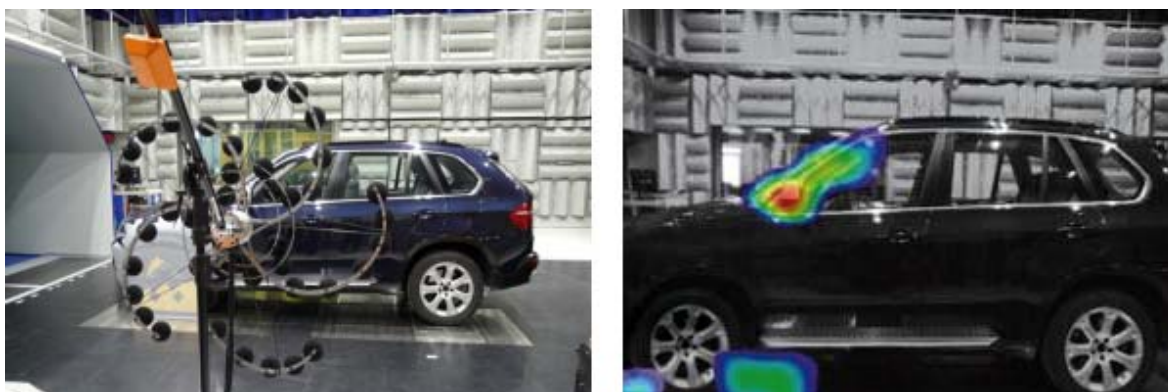
Obr. 9.2 Měření aero akustického hluku v aerodynamickém tunelu [4]
