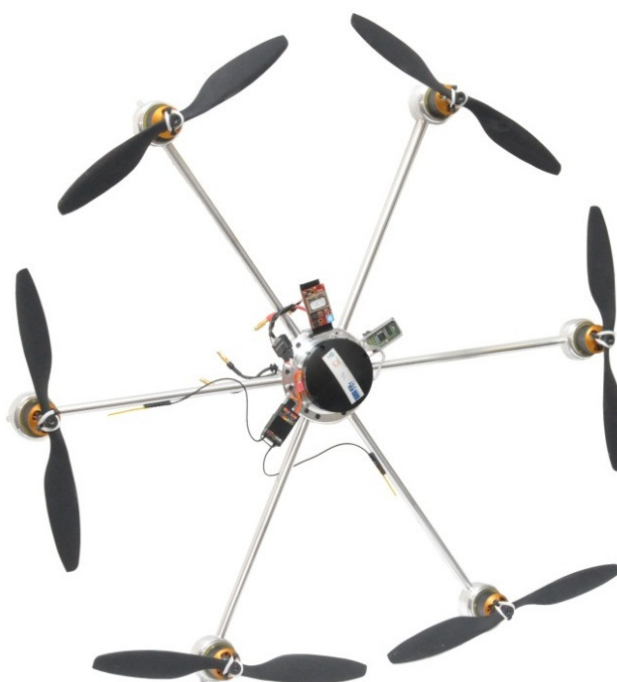
Obr. 2.1 Multikopter se šesti rameny
