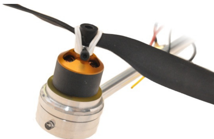
Obr. 2.6 Sestavená pohonná jednotka vrtule-motor-měnič
