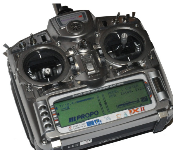
Obr. 2.9 Dálkový ovladač s obousměrnou komunikací
