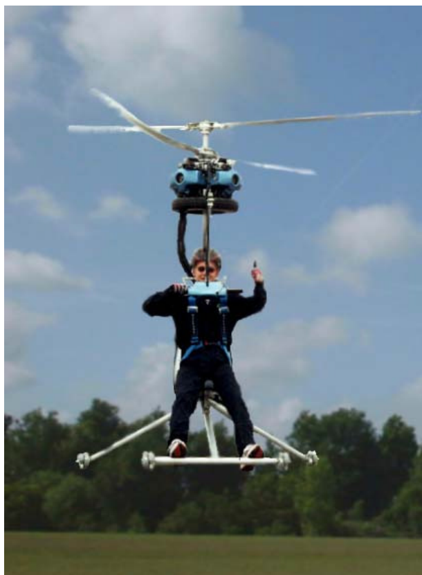
Obr. 7.7 Osobní koaxiální helikoptéra GEN-H4 z roku 2006. [Zdroj: gen-corp.jp]
