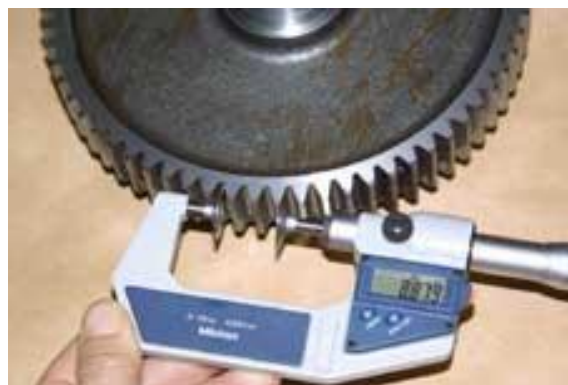
Obr. 8.52 Kontrola rozměru přes zuby
