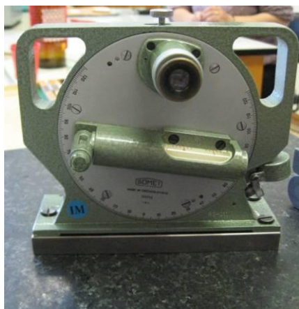
Obr. 6.1 Optický sklonoměr a zorné pole sklonoměru
