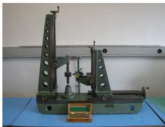
Obr. 8.47 Přístroj k měření ozubených kol AMY 0003
