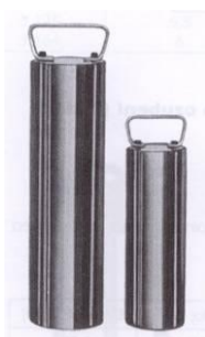
Obr. 5.1 Průměrné válce a schéma kontroly úhelníku pomocí průměrného válce
