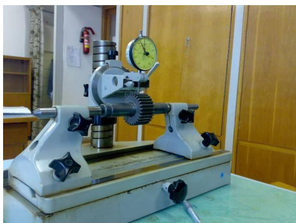
Obr. 8.46 Přístroj Carl Zeiss Jena pro měření radiálního házení
