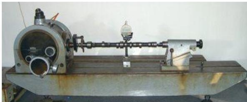
Obr. 9.5. Kontrola vačky s pomoci optické dělicí hlavy a číselníkového úchylkoměru
