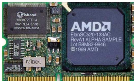
Obr. 2.19 Procesorový modul DIMM-PC zasunutý v DIMM 144 konektoru. Rozměr 68x40mm.
