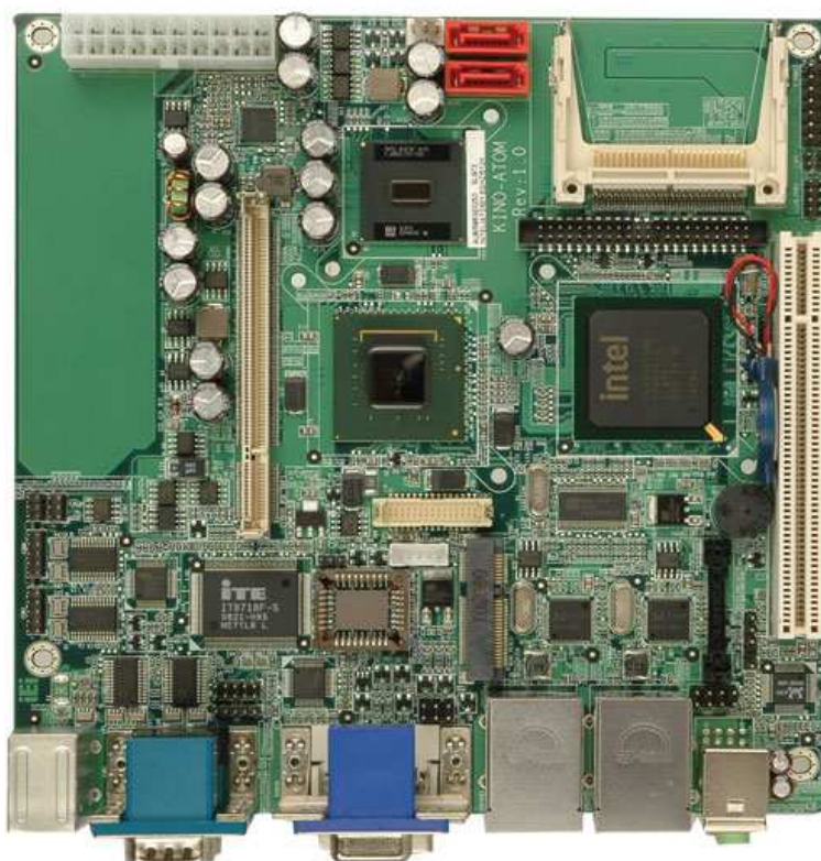
Obr. 2.25 Mini ITX Motherboard typ KINO-945GSE-N270, s rozměry 170mm x 170mm. ( http://www.icpamerica.com/products/single_board_computers/motherboard/mini_itx/KINO_945GSE_N270.html )
