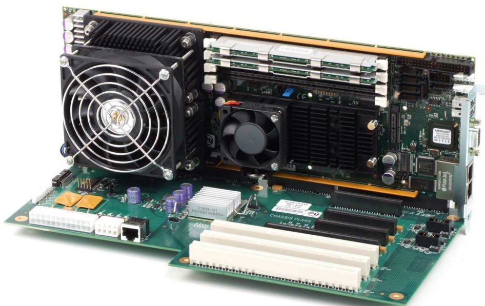
Obr. 2.8 Základní deska osazená PICMG 1.3 procesorovou deskou (SBC) v SHB PICMG slotu.
