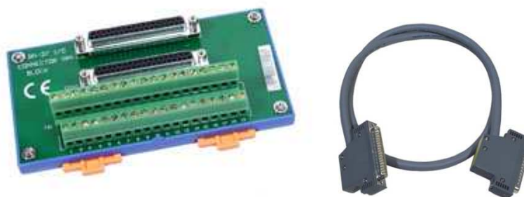
Obr. 3.11 Modul DN-37 svorkovnice – označena jako TB1 (s kabelem CA-3710) vhodná pro kartu PISO-P8R8.
