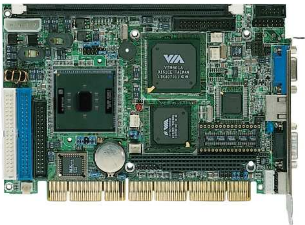
Obr. 2.11 PCISA-C400 (PCI / ISA) „Half Size SBC“. Tato procesorová karta se zasouvá do PCISA slotu na pasivní základní desce. ( http://www.aonecorp.co.kr/products/single/pcisa-c400.htm ).
