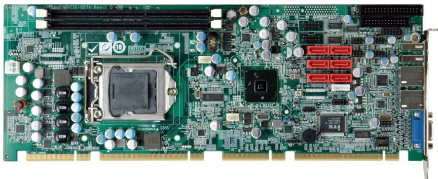
Obr. 2.7 Procesorová deska PCIE-Q57A plné délky určená do PICMG 1.3 slotu.
