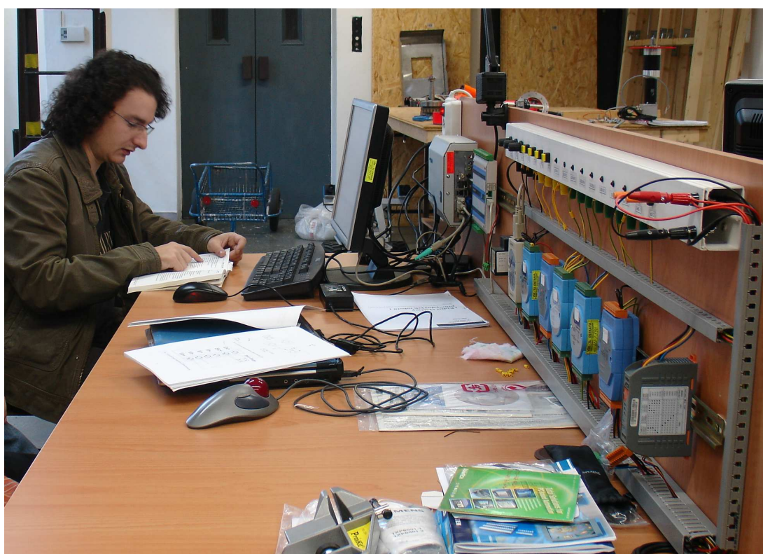
Obr. 1.1 Pracoviště s moduly distribuovaných binárních a analogových vstupů a výstupů.
