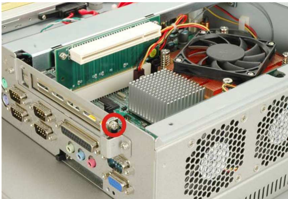
Obr. 2.14 Způsob vyvedení PCI slotu u PPC WIDS-517A/9455 pomocí redukce.
