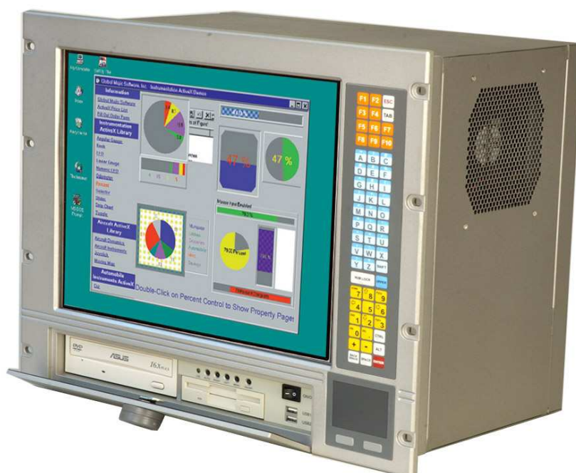
Obr. 2.1 Vzhled IPC v provedení pracovní stanice- typ WS-875GSATX/832AP/T-R výrobce iEi ( www.ieiworld.com ).
