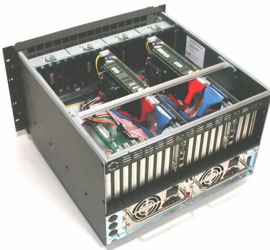
Obr. 2.5 Průmyslové šasi s osazenou dvou-systémovou pasivní sběrnici.
