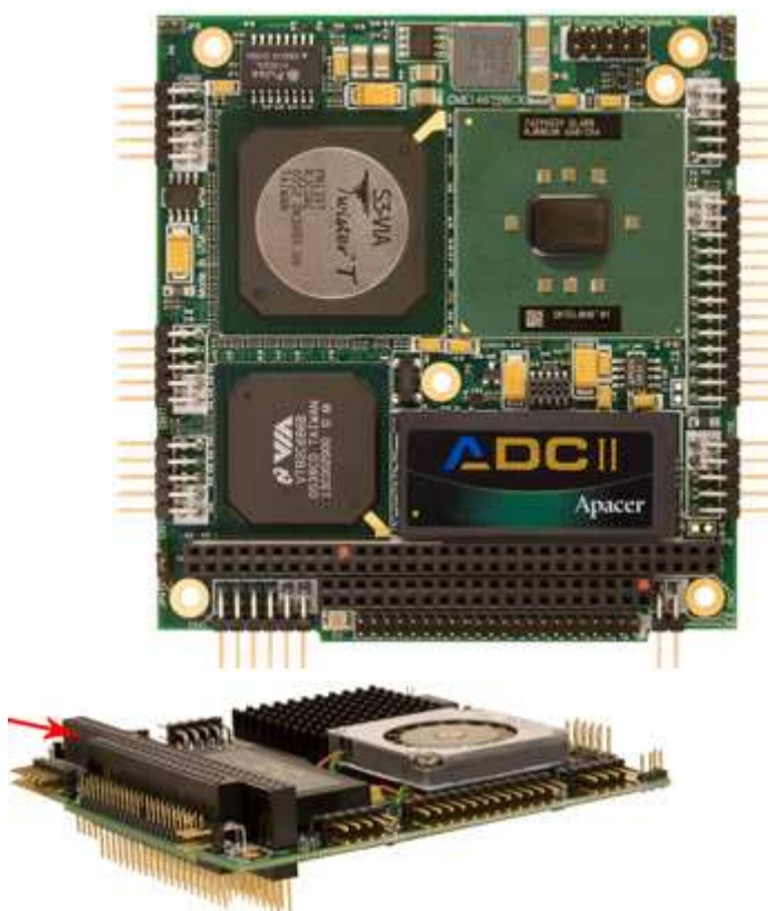
Obr. 2.16 Procesorový modul stavebnice PC104 CME146786CX650HR ( http://www.rtd.com ).
