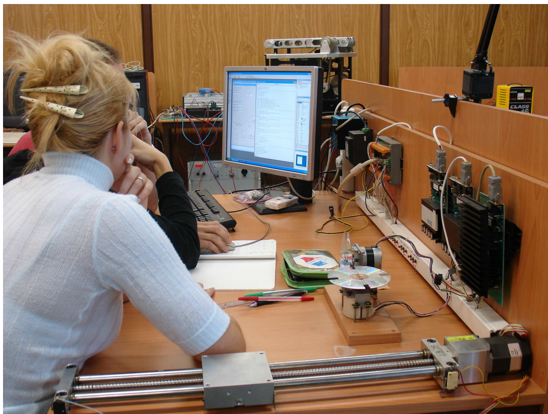
Obr. 5.22 Laboratorní pracoviště víceosých systémů s kartou PISO-PS400.
