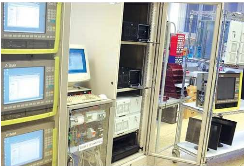
Obr. 4.19 Pracoviště pro zahořování AutoCont IPC a.s.
