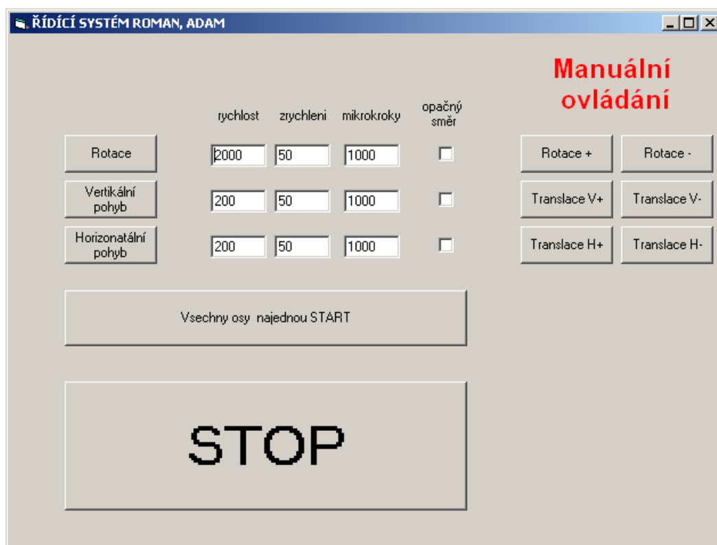
Obr. 5.6 Vzhled ovládacího panelu programu pro ovládání školního manipulátoru BURNOS.
