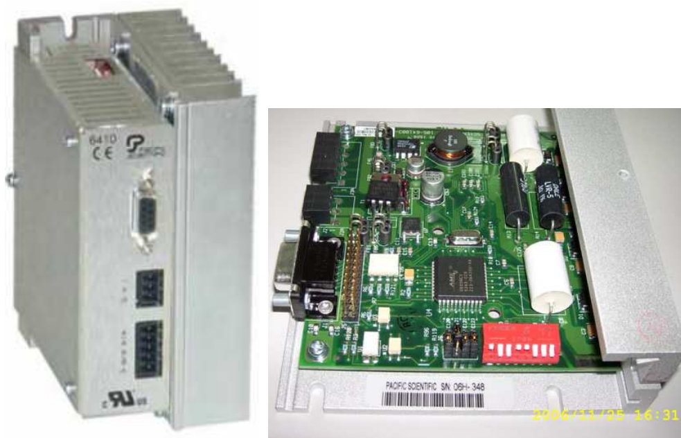
Obr. 6.6 Výkonový modul 6410-001, na pravém obrázku bez krytu a chladiče.
