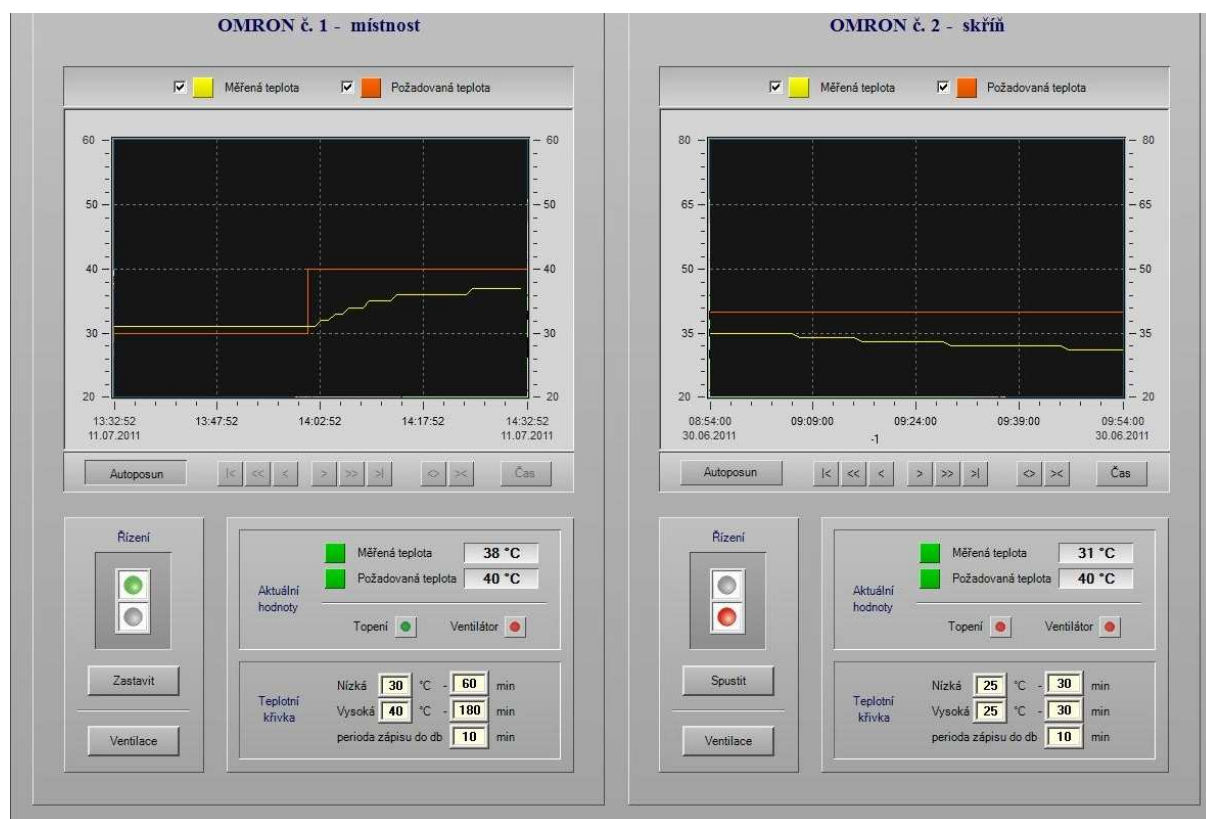
Obr. 4.11 Průběhy teplot v zahořovně – v levé části místnost, v pravé skříň.
