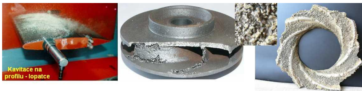
Obr. 4.20 Oběžné kolo čerpadla poškozené kavitací [11]
