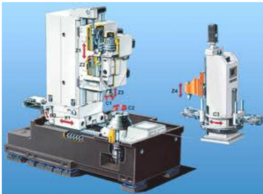
Obr. 5.2-2 Konstrukce obrážecky se saněmi obrážecí hlavy [44]
