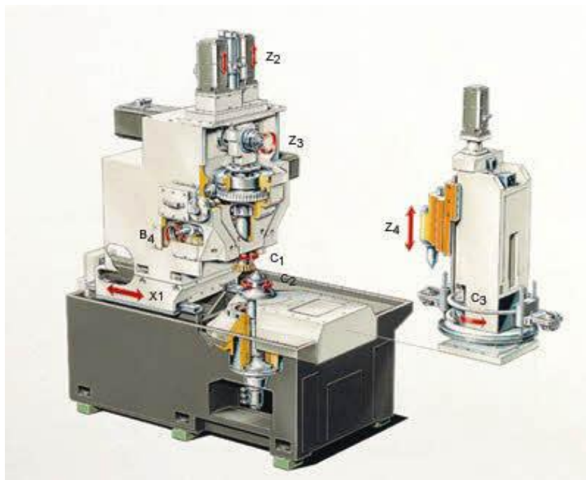
Obr. 5.2-1 Konstrukce obrážecky bez saní obrážecí hlavy [44]
