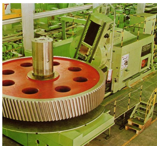
Obr. 2.1-2 Obrážčky na principu MAAG typu SH-75K (vlevo) a SH-600/735SE (vpravo) pro průměry kol 0,75 m, resp. 7,35 m
