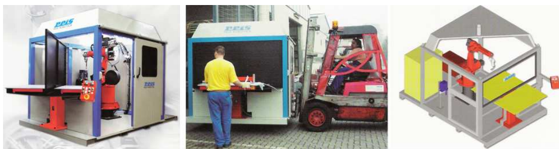
Obrázek 2.12 – Schéma RTP kde PR i periferní zařízení jsou stabilní
