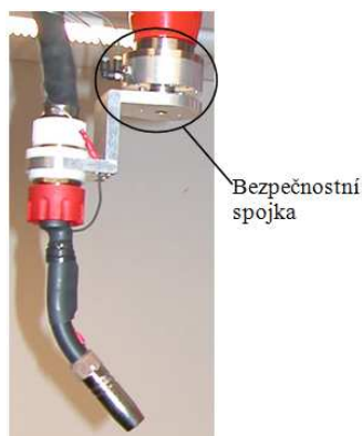
Obrázek 5.6 – Příklady technologického efektoru s bezpečnostní spojkou
