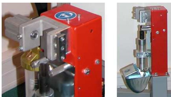
Obrázek 5.8 – Příklad mechanického čištění svařovací hubice
