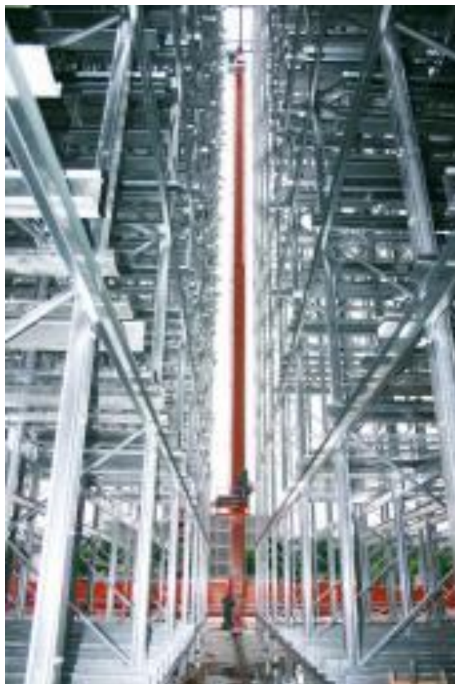
Obr. č. 5.8: Automatizované základací systémy
