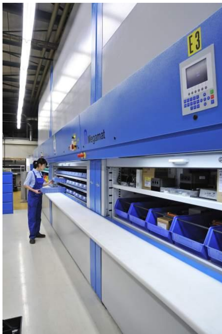
Obr. č. 5.9: Automatizované skladovací systémy, páternosterový systém Kardex Megamat
