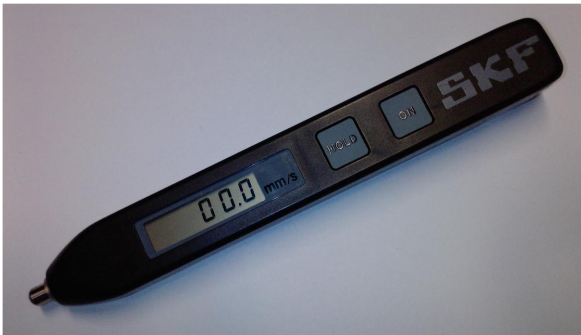
Obrázek 1.1 – Vibropen – pro měření celkových vibrací 10 – 1000 Hz
