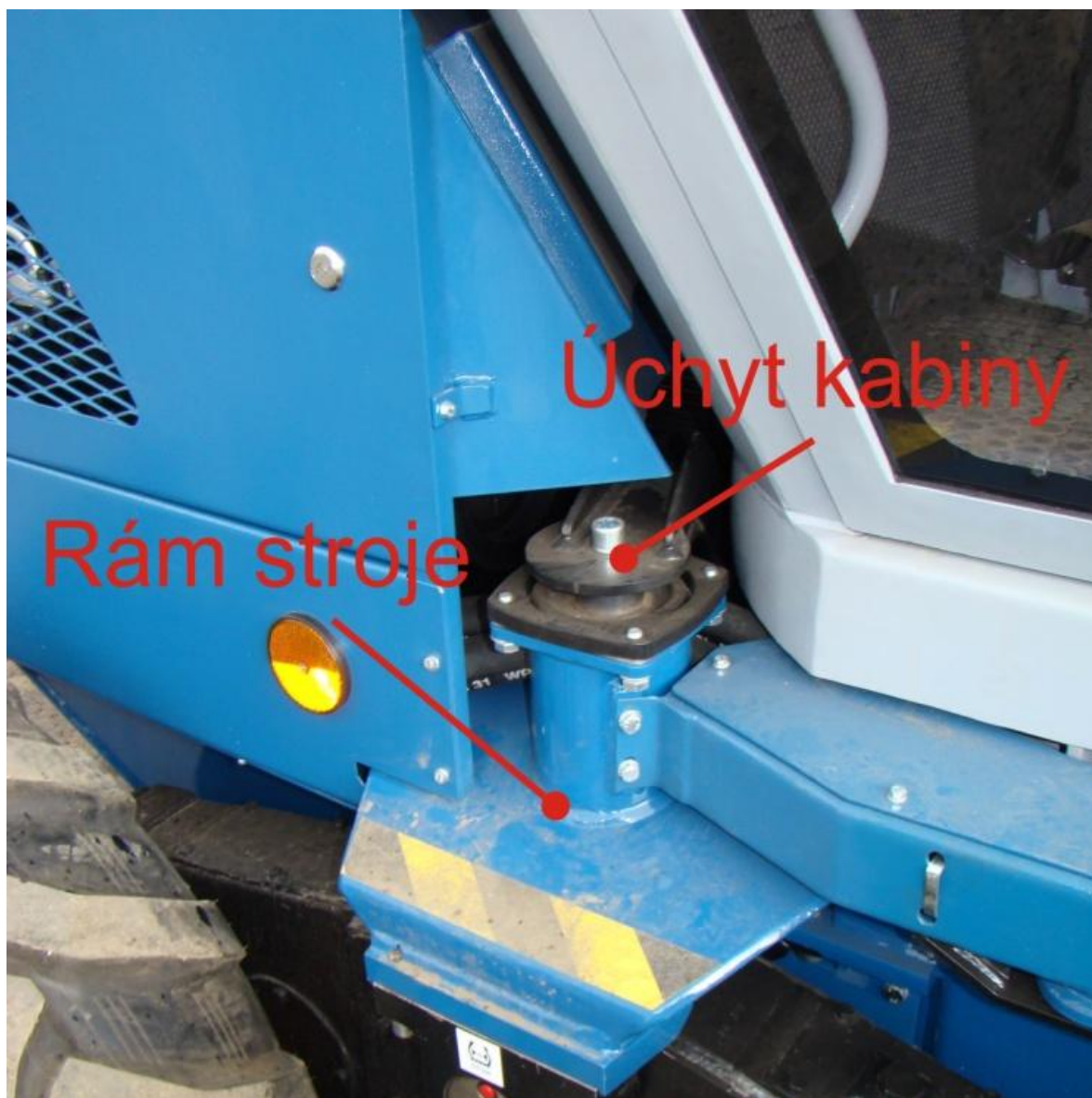
Obrázek 1.4 – Měřící místa úchytu kabiny a rámu
