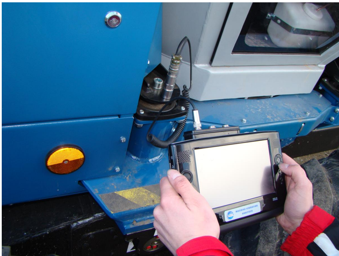
Obrázek 1.2 – Měření za pomoci vibračního analyzátoru Adash VA 4 Pro
