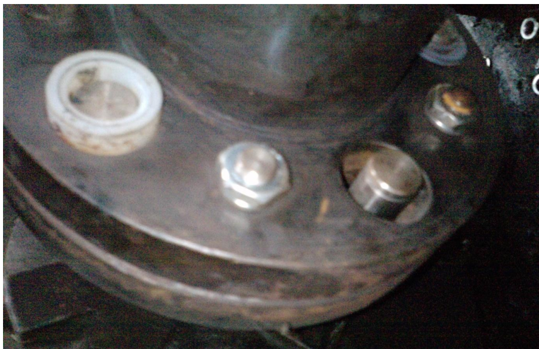
Obrázek 2.15 – Zobrazení Boční pohled na vadnou spojku s vypadanými silonovými kroužky
