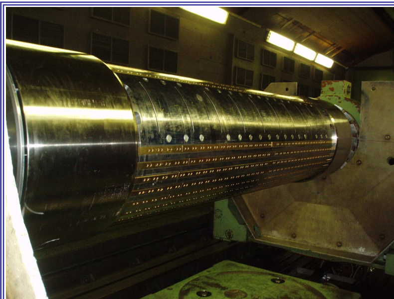
rotor generátoru (cca 70 MW) na vyvažovačce - je vidět řada dílčích vyvažovacích zátek a místa konečného vyvažování
