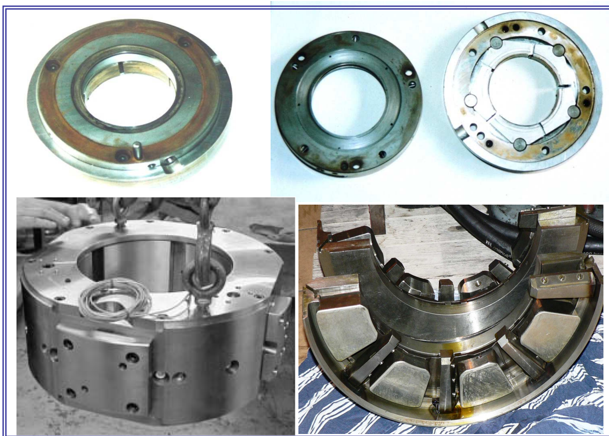
Obr. 4.4.9 - Příklady konstrukce kluzných segmentových ložisek
