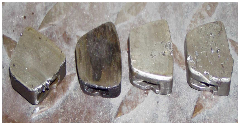
Obr. 4.4.11 - Příklady poškození kluzných ložisek
