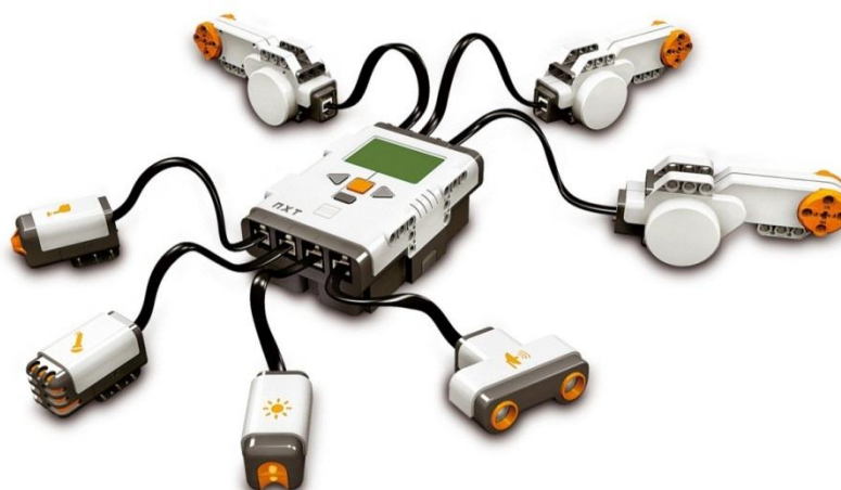
Obr. 2.7 – Připojení snímačů a motorů [LEGO®]
