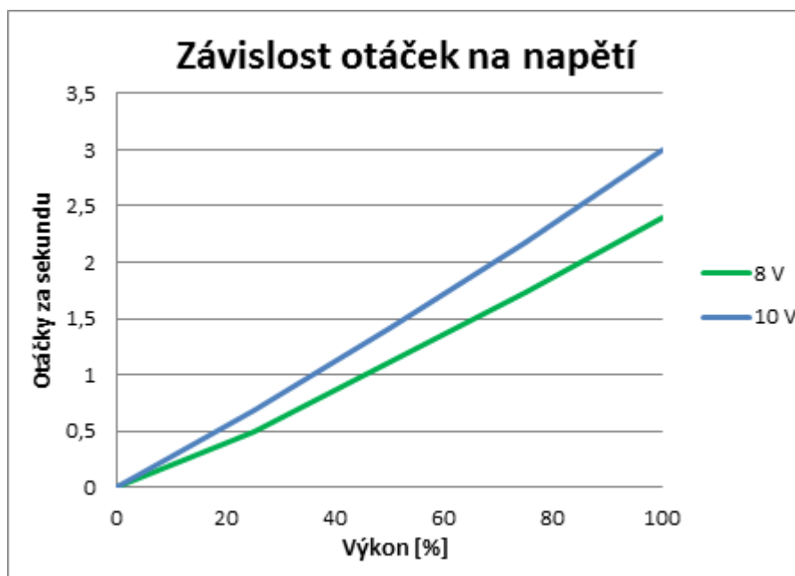
Graf 4-1 Závislost otáček motoru na napětí baterie.
