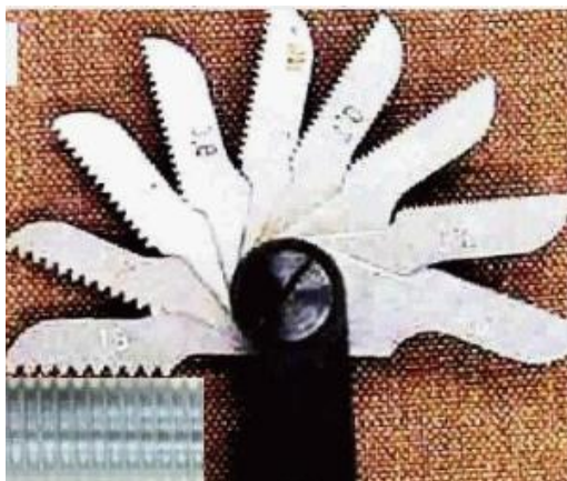
Obr. 47 Hřebínkové šablony pro kontrolu stoupání závitu
