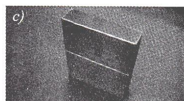
Obr. 22 Sestavení koncových měrek – dvě robustní měrky
