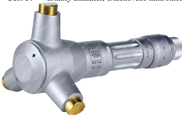
Obr. 15 Třídotykový dutinoměr pracující na principu mikrometrického šroubu
