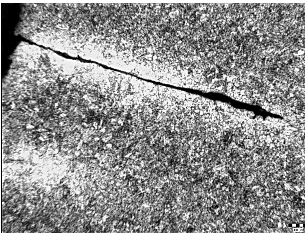
Obrázek 9-10: trhlina zasahující téměř do poloviny TMZ oblasti (50x) [18].
