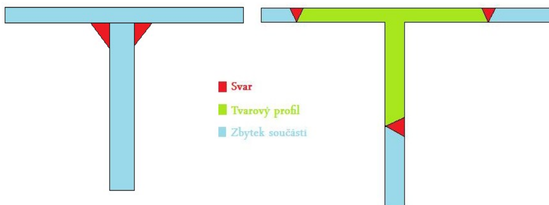
Obrázek 11-6: Nahrazení koutového svaru profilem tvaru T [18].
