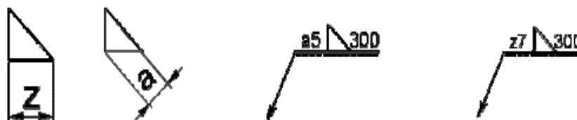
Obrázek 7-7: Značení koutových svarů s upravenou stykovou plochou [65].
