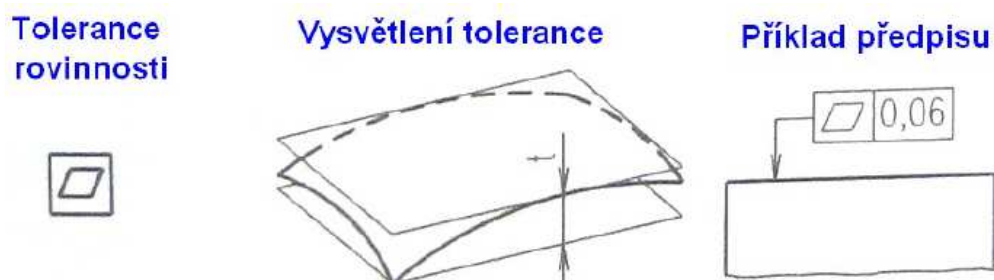
Obr. 26 Vysvětlení a praktický příklad předpisu rovinnosti
