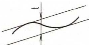
Obr. 24 Vysvětlení a praktický příklad předpisu přímosti
