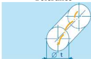
Obr. 38 Příklad znázornění souososti a soustřednosti (lit. společnosti HOMMEL CS s.r.o.)
