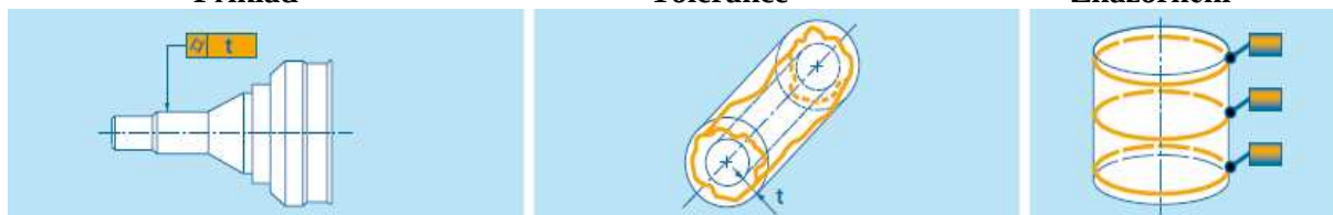
Obr. 29 Příklad znázornění válcovitosti (lit. společnosti HOMMEL CS s.r.o.)
