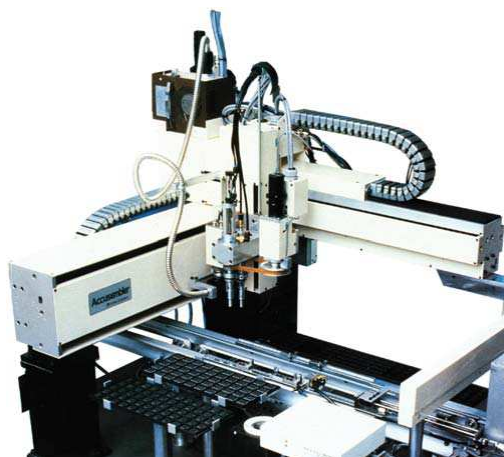
Obr. 58 Montážní kartézský robot ACCUSEMBLER TM japonské firmy SEIKO-EPSON
