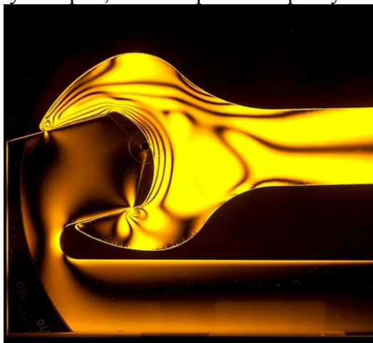
Obrázek 1 Fotografie modelu maticového klíče z fotoelasticimetrického experimentu
