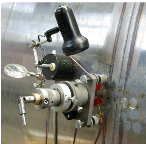
Obrázek 2 Aplikace metody odvrtání otvoru u bandážovaných válců
