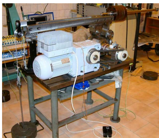
Obrázek 5 Zkušební zařízení TUORS pro výzkum kontaktní únavy
