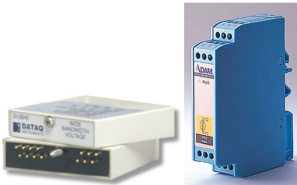
Obr. 6 Moduly pro úpravu/přizpůsobení signálu. Vlevo – modul 5B40 – určen do zasunutí do montážní desky, vpravo modul ADAM3013 určený pro montáž na DIN lištu.
