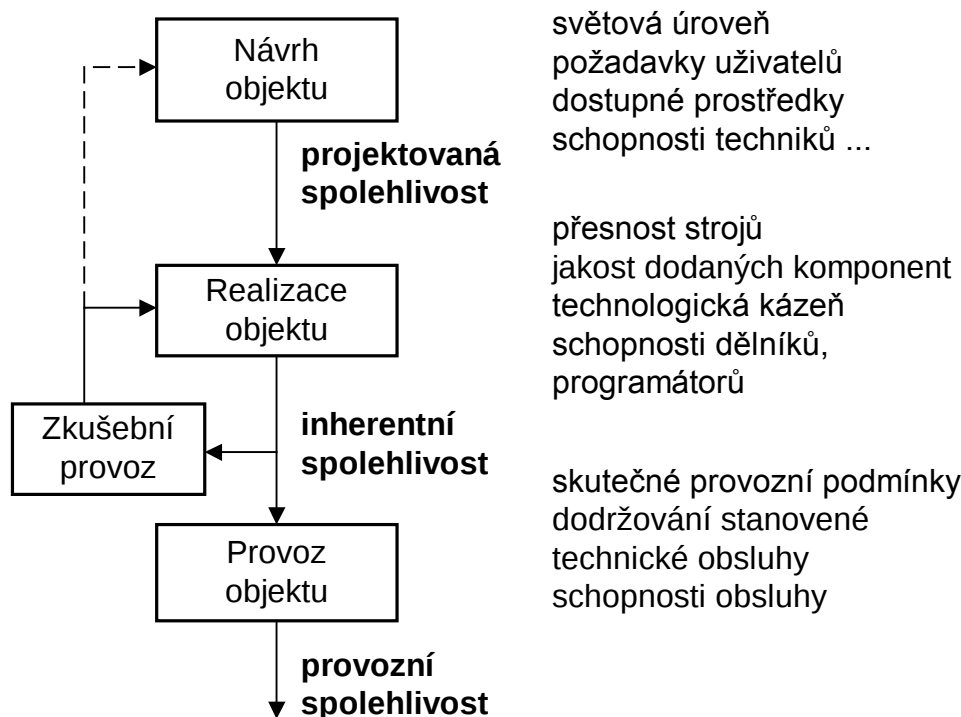
Obr. 1.1 Návaznost řešení problematiky spolehlivosti v jednotlivých obdobích návrhu, realizace a provozu.
