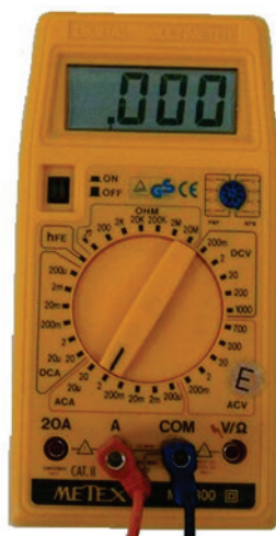
Obr. 6 Digitální multimetr Metex M-3800.
