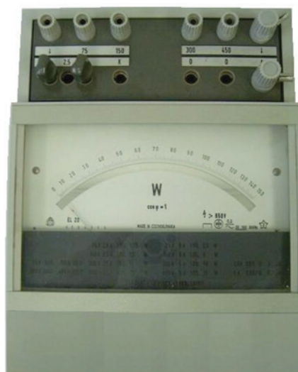
Obr. 5 Ferodynamický wattmetr EL 20.
