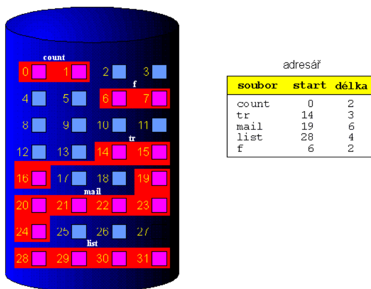
Obrázek 3 - Souvislá alokace diskového prostoru
