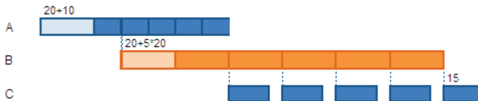
Obrázek 2 - Schéma souběžného předávání dávky
