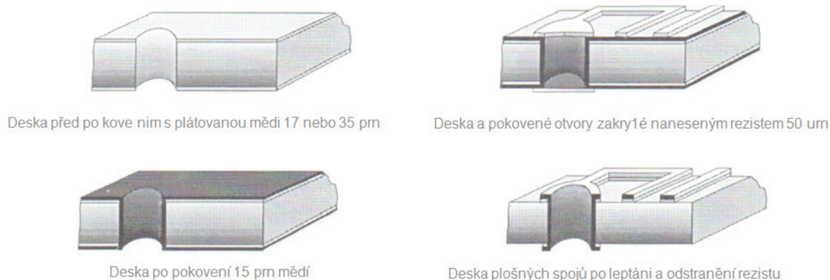
Obr. 16 Metoda pokovování panelu – „Panel plating“
