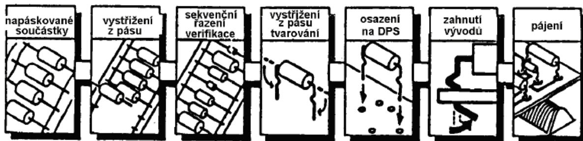
Obr. 7. Znázornění automatizované montáže elektronických součástek
