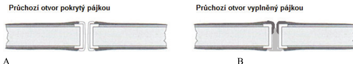
Obr. 24 Ochrana průchozích otvorů tekutou fotocitlivou nepájivou maskou
