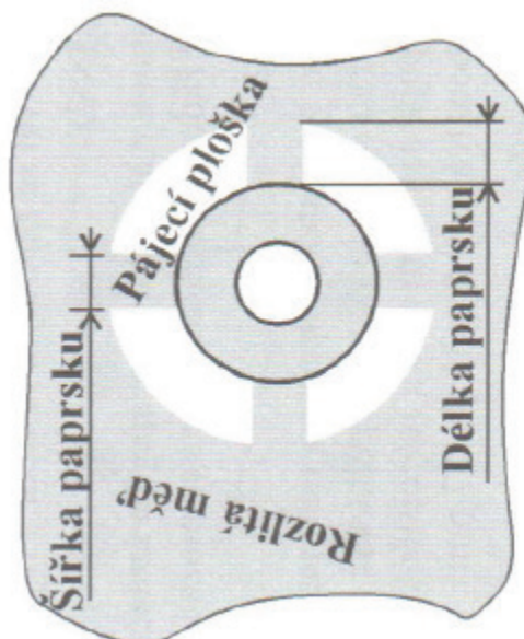
Obr. 4 Definice termální plošky
