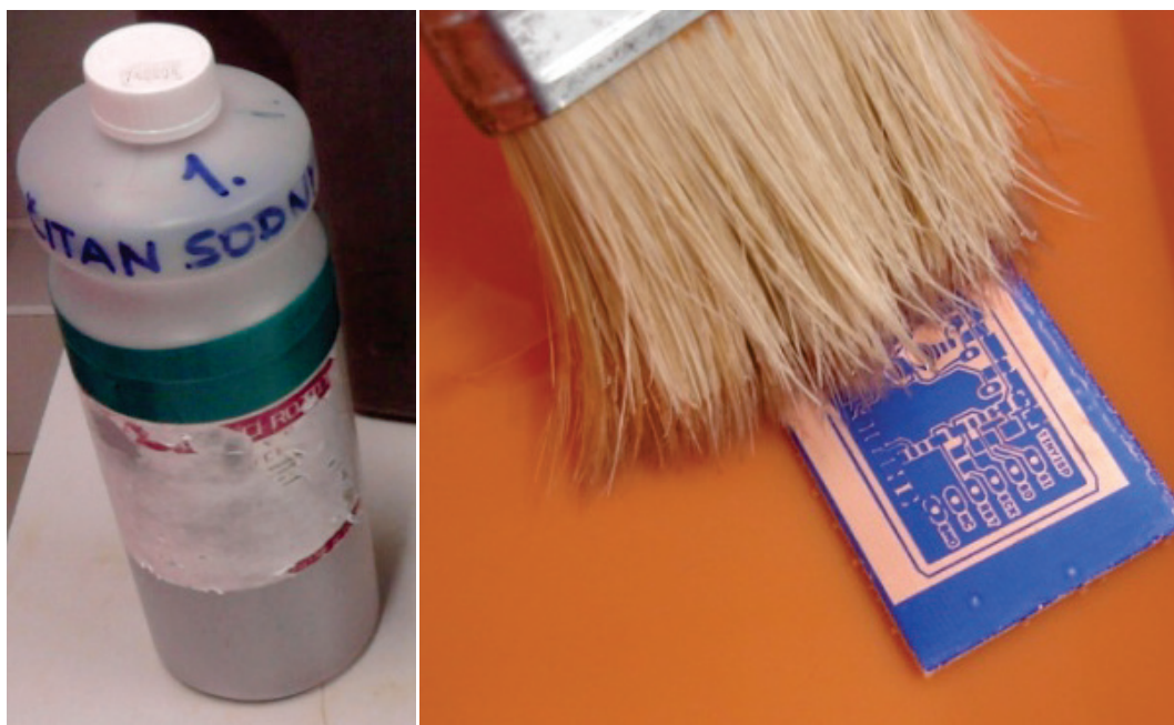
Obr. 12. a) leptací roztok 1-uhličitan sodný, b) leptací proces
