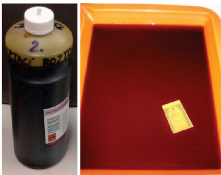
Obr.14. a) Leptací roztok chlorid železitý, b) položení DPS do roztoku
