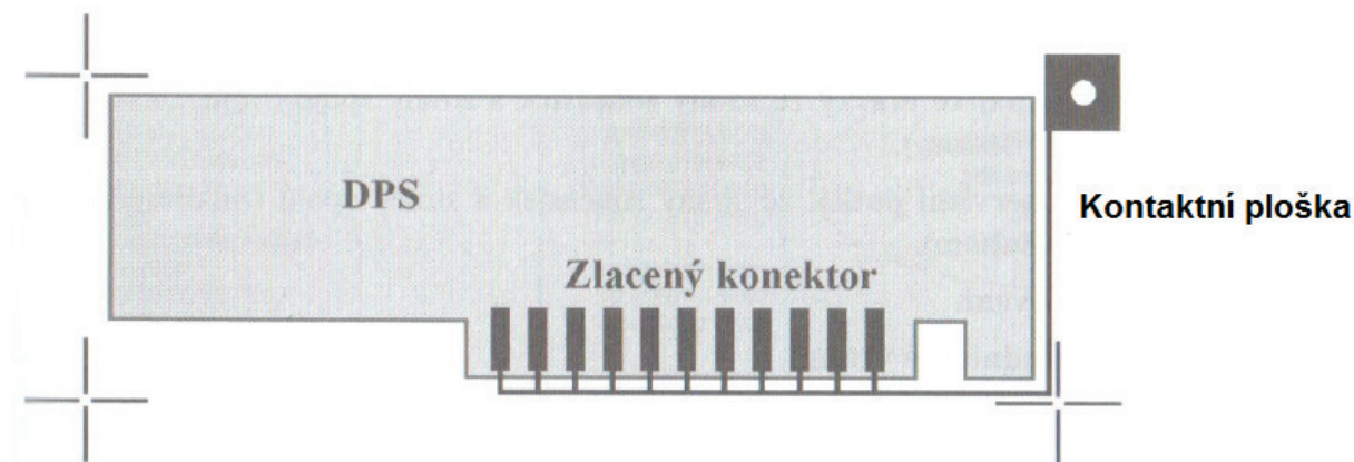
Obr. 8 Propojení plošek zlaceného konektoru
